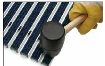
3. Neue Ripsstreifen mit Selbstklebeband in das Aluprofil einkleben und ggf. mit einem Gummihammer den Klebeprozess verstärken.
